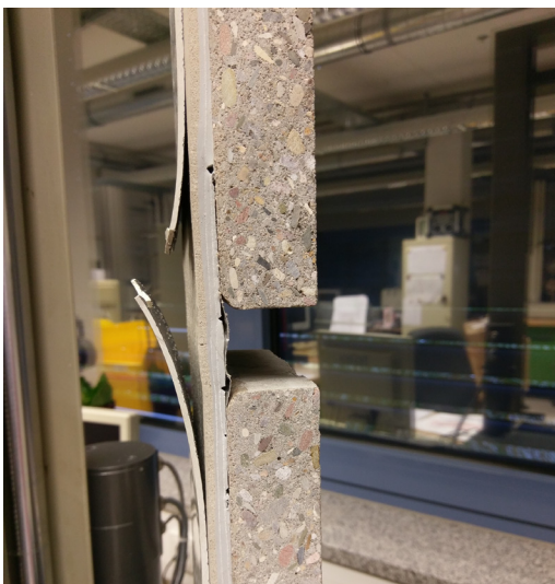
Abbildung 9: Versagen der oberen Deckschicht nach einer Dehnung von ca. 11 mm
