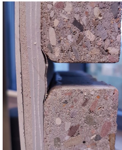
Abbildung 7: Fugendehnung bei ca. 5 mm
