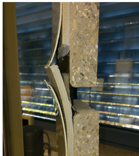
Abbildung 10: Totalversagen des NBT-Fugensystems nach einer Dehnung von ca. 28 mm
