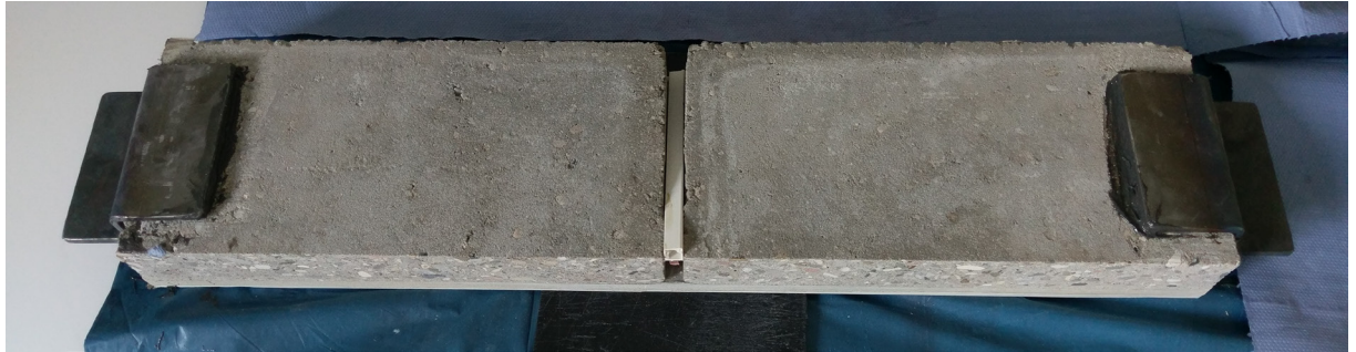
Abbildung 3: Anbringen der Metallhalterungen
