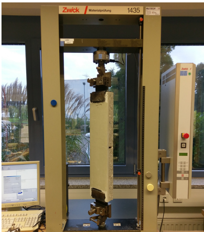
Abbildung 4: Einspannung des Probekörpers in die Universalprüfmaschine Zwick Typ 1435
