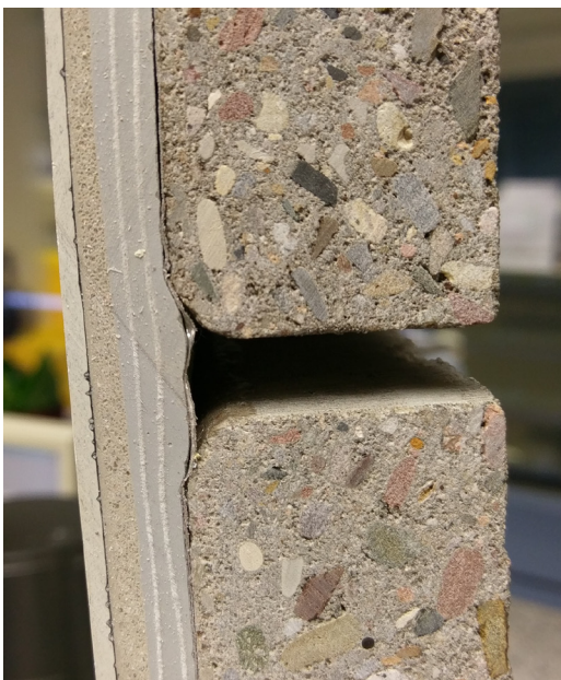
Abbildung 6: Fugenstauchung bei ca. 3 mm
